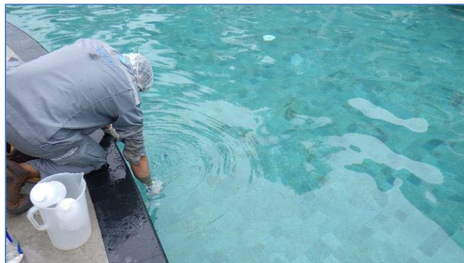
ภาพถ่ายที่ 3.4.11-2 การตรวจวัดคุณภาพน้ำจากสระว่ายน้ำ
