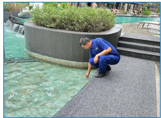
ภาพถ่ายที่ 3.4.11-1 การตรวจเช็คความเป็นกรดต่าง และคลอรีนอิสระคงเหลือทุกวัน
