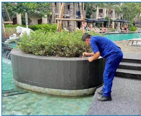
ภาพถ่ายที่ 3.4.11-1 การตรวจเช็คความเป็นกรดต่าง และคลอรีนอิสระคงเหลือทุกวัน
